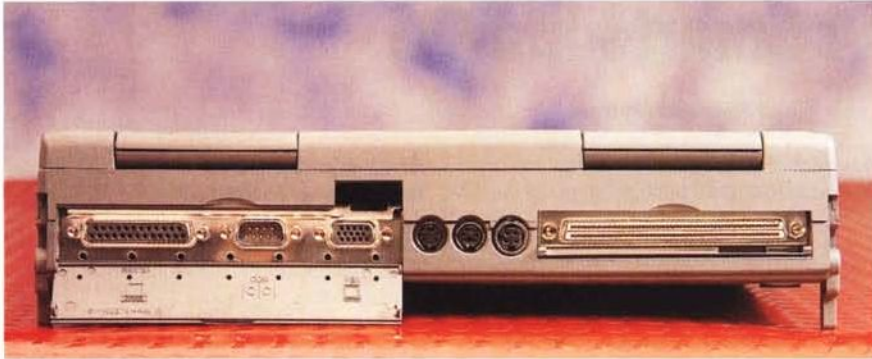
Sul retro le porte di connessione (compresa l'interfaccia a raggi infrarossi IrDA). Sul lato destro ingressi e uscite audio e l'unità floppy disk.
